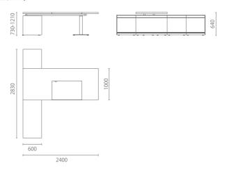
Model 型号: SONO-BT-01-L/R Size 尺寸: 台面 W2400 D1000
